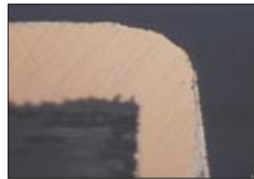
Fig 2. Exempel på hur tunn varmförtening blir över hålkragens skarpa kant, < 1 µm.
