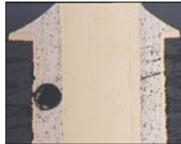
Fig 6. En håligheter i plätningen har stängt inne vätska, vilket orsakat en utgasning vid lödning.
