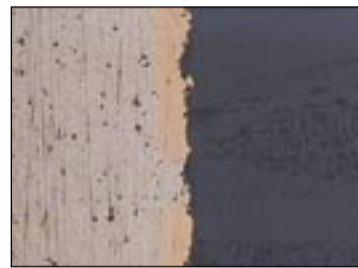
Fig 4. En håligheter i kopparplätningen som inte upptäckts vid eltest.
