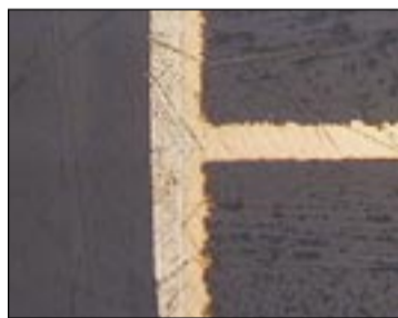
Fig 5. Anslutning mellan ett innerlager och kopparplätning i hålvägg.
