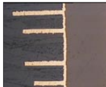
Fig 8. Innerlagren ligger förskjutna. En typisk registreringsavvikelse.
