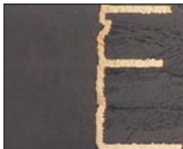
Fig 7. Tydlig kavitet i hålväggen orsakad av urrivning vid borrning.
